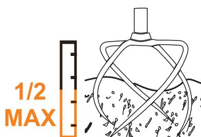
2. Закручивающим движением по часовой стрелке погружаем зубья культиватора в землю. Глубина зависит от плотности почвы: чем плотнее почва, тем меньше глубина. Рекомендуемая глубина первичного погружения не более чем 1/2 от высоты зубьев.
