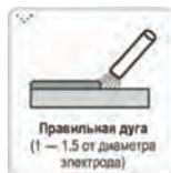
Очень важно, чтобы длина дуги была правильной, т.к. это влияет на сварочный ток и напряжение. Непрочный сварочный шов является результатом неправильного тока сварки. Наклон электрода (вперед) должен составлять  $70^\circ$  или  $80^\circ$ . При слишком большом наклоне сварочный шов может стать пористым.
