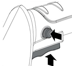
Убедитесь, что в зоне шнеков нет снега и посторонних предметов. Для включения нажмите и держите нажатой кнопку блокировки, прижмите к рукоятке клавишу включения шнека. После включения вращения шнеков отпустите кнопку блокировки. Для выключения отпустите клавишу включения.
