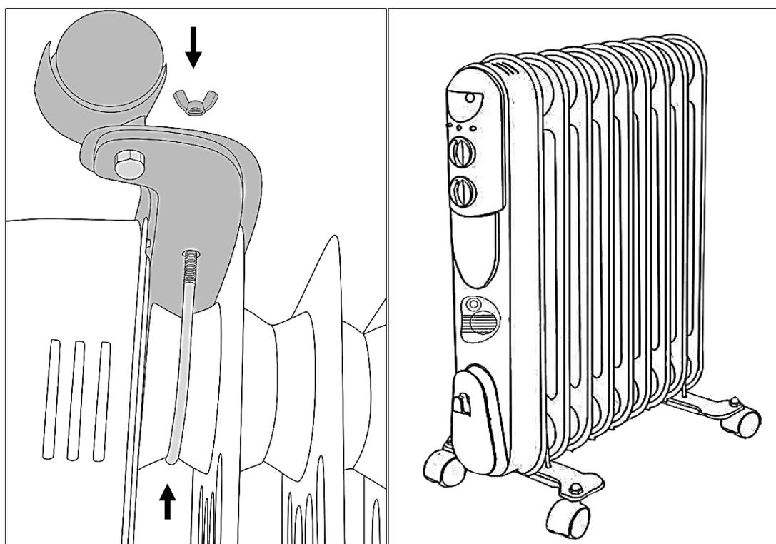
Рис.2. Установка колёс
